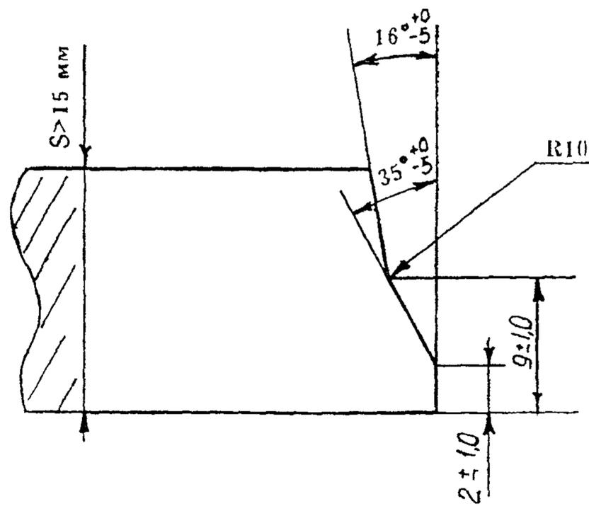
Рис. 1 Разделка кромок торцов трубы.
